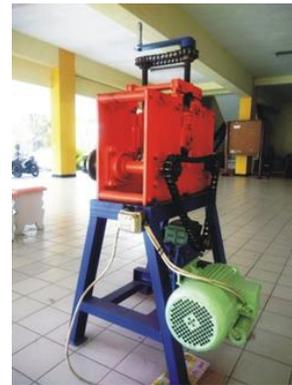
Gambar 9. Mesin *Roll Bending* Pipa Persegi
