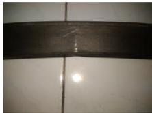
Gambar 3. Cacat Tekuk (*Buckling*)
