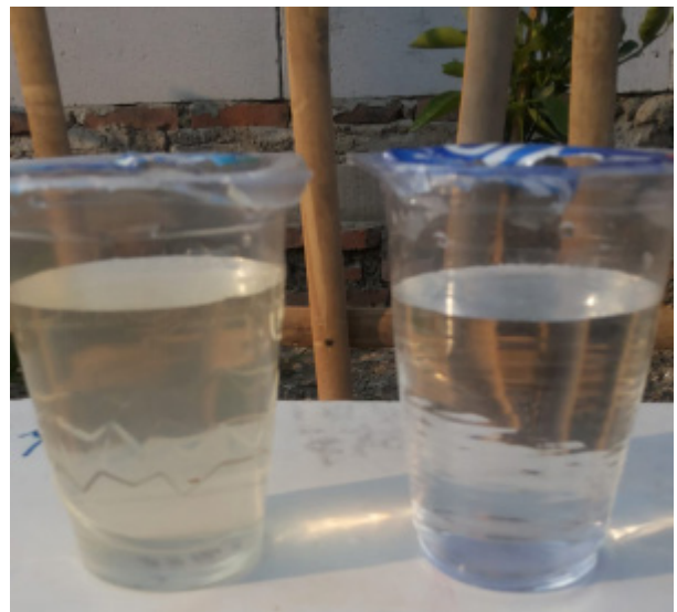
Gambar: air sebelum dan air sesudah di saring dengan saringan pasir lambat
