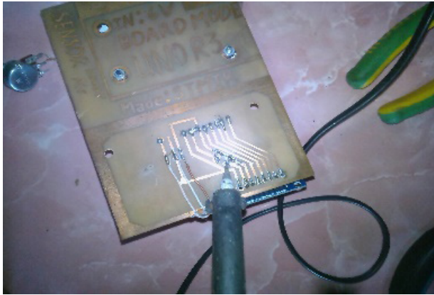
Gambar 6. Proses penyolderan rangkaian
