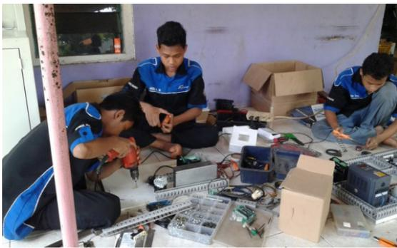
**Gambar 2. Instalasi frame mesin ukir kaligrafi kayu**
