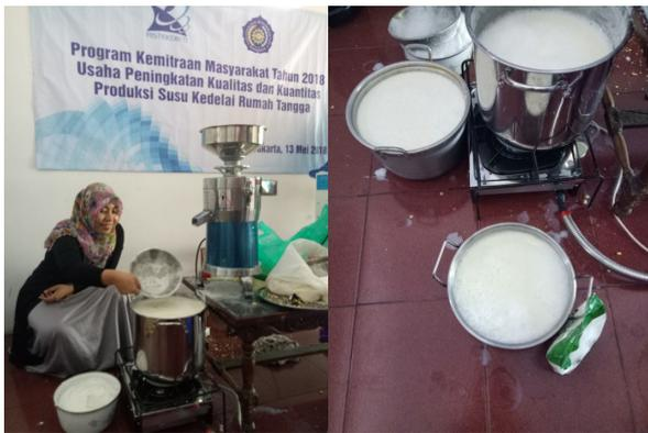
Gambar 3. Proses pemasakan susu kedelai dengan alat pemasak khusus
